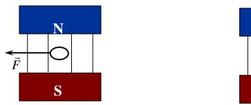
4. Записать вывод. Магнитное поле действует с силой на проводник с током. Направление движения проводника будет зависеть от того, в каком направлении по нему проходит ток. Если мы изменим направление движения тока, то проводник отклонится в другую сторону. Так же изменится направление движения проводника при изменении местами полюсов постоянного магнита.
