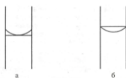
Рис. 5. Правильное измерение объемов неокрашенных (а) и окрашенных (б) жидкостей
