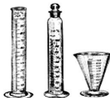
Рисунок 4 – Мерные цилиндры и мензурка
